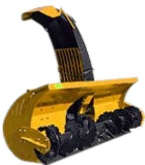
Шнекороторный снегоочиститель (шнекоротор, снегоочиститель) - навесное оборудование, которое отбрасывает снег на расстояние от убираемой поверхности, либо сыплет его по желобу в рядом идущую грузовую машину. Шнекоротор справляется со снежным покровом до 45-80 см.
